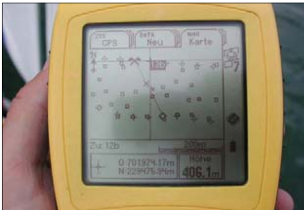
Auf der Transektlinie wird bei jeder Änderung der Vegetationsdichte und/oder -zusammensetzung eine Abschnittsgrenze gesetzt und per GPS eingemessen. Der Taucher gibt diese Grenze per Signal mit der Boje dem Untersuchungsleiter für die Positionsmessung bekannt. Auch die vorgängig eingemessene Transektlinie ist auf dem Display ersichtlich, ebenso die ständige Position des Tauchers. Damit kann die korrekte Einhaltung der Tauchstrecke überwacht werden.
